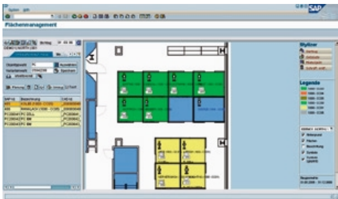
Abbildung 4: Durch eine CAD-Integration ist es möglich, im SAP ein eigenständiges Umzugsmodul bereit zu stellen. Damit kann der Anwender im SAP an einer zentralen Stelle über eine CAD-Oberfläche die verschiedenen SAP-Objekte im CAD platzieren oder bestehende Platzierungen per Mausclick entfernen.
